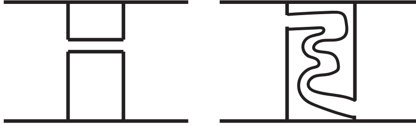
图 4.28: 两种多孔介质模型, 左右具有不同孔隙率。
